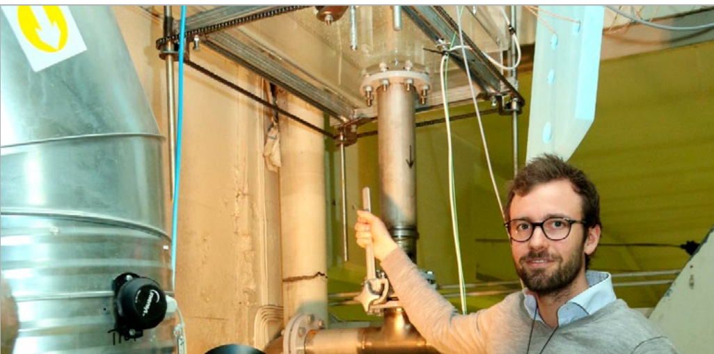
Modell av luftputekammer i størrelse 1:65. Foto: Håkon Barstad i Europower
