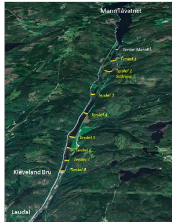
Minstevannførings-strekningen med elveterskler i Mandalselva ovenfor Laudal kraftverk. MBV vurderer samspillet av ulike tiltak på ulike brukerinteresser langs den regulerte elvestrekningen. Foto: Agder Energi
