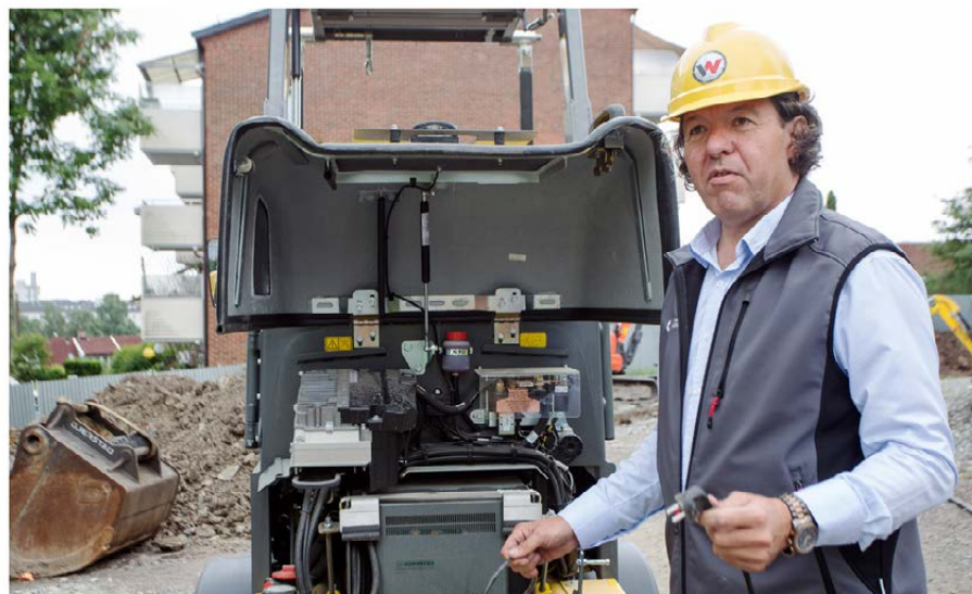
Jan Gunnar Halstvedt viser hvor batteriet plugges inn når anleggsmaskinen skal lades. (Foto: Mari Gisvold)
