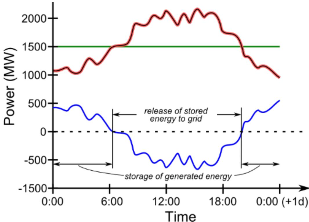
Termiske kraftverk er mest effektive når de kjøres med jevn last. Endringer i forbruk i løpet av døgnet kan med fordel håndteres av andre typer kraftverk, for eksempel pumpekraftverk eller gasskraftverk
