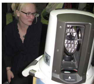
Doktorgradsstipendiat Kari Bråtveit bruker en mobil laserscanner til å kartlegge innsiden av tunneler. Foto: Claude R. Olsen
