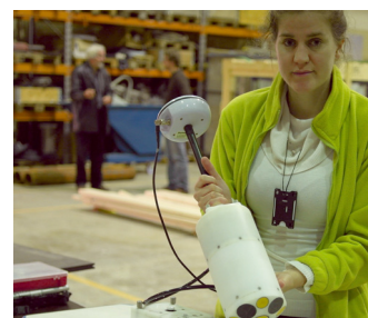
Doktorgradsstudent Roser Casas-Mulet viser de akustiske dopplermålerne som sitter under flyteren. De måler vannhastigheten i elven i tre dimensjoner. Foto: Claude R. Olsen
